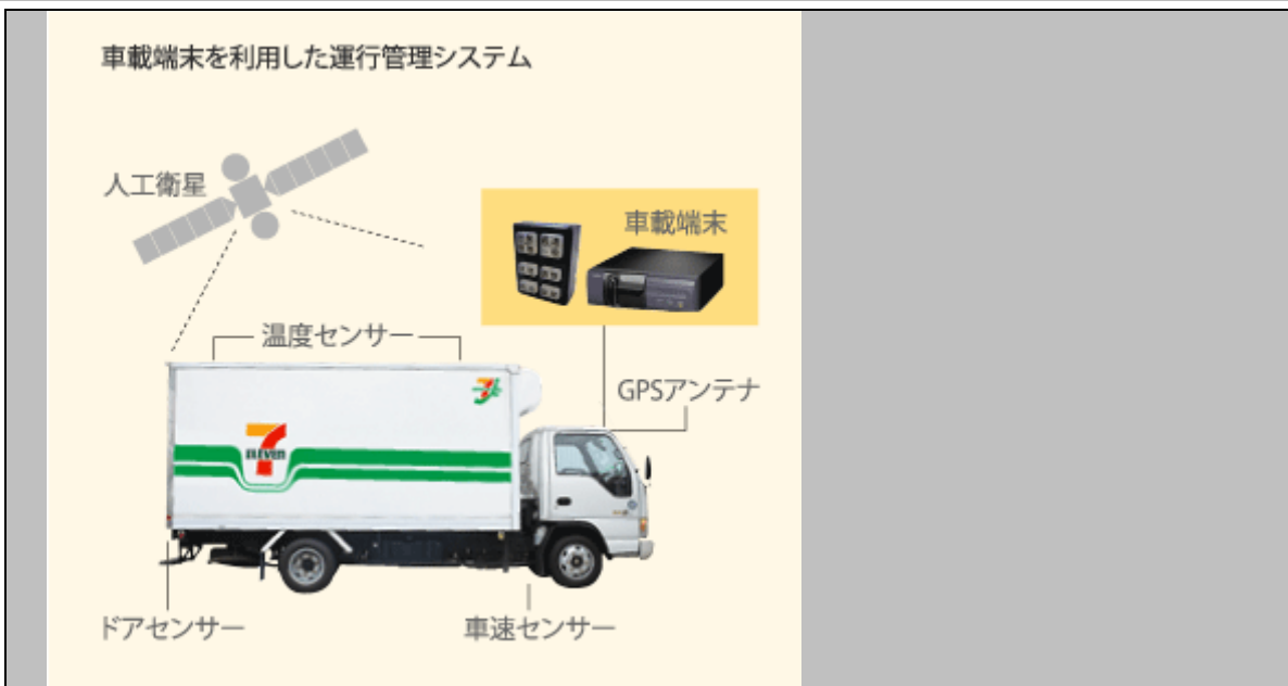
Fig 6-28 走行管理システム 81
