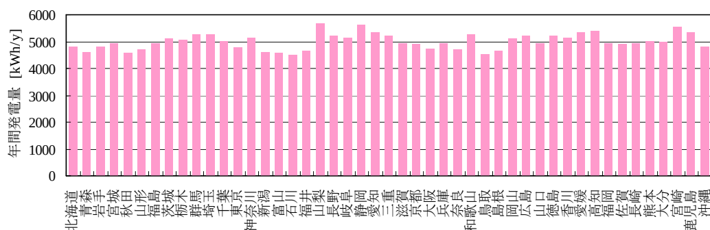
図 1. 3.5 kW 住宅用太陽光発電システムによる都道府県別の年間発電量
